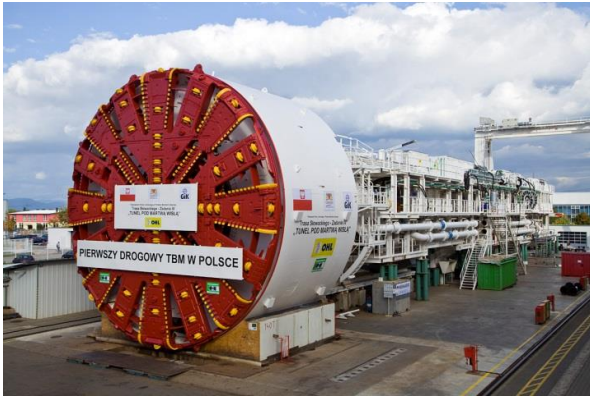
Bild3: Für das Projekt Slowacki -Tunnel konstruierte und fertigte die Herrenknecht AG die mehr als 12,5 Meter breite TBM S-745 vom Typ Mixschild.
