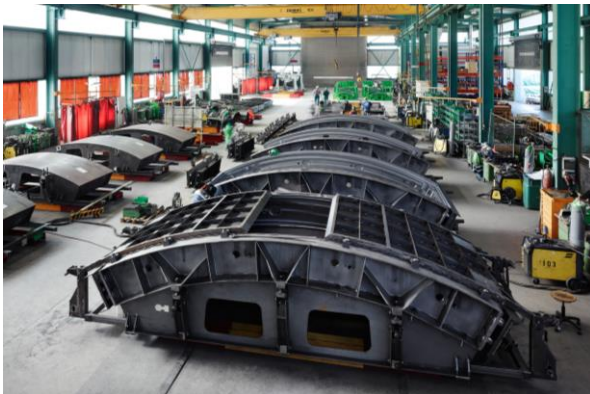
Bild5: Herrenknecht Formwork lieferte für das Projekt millimetergenaue Schalungen für die Produktion von 18 Tonnen schweren Tübbing.
