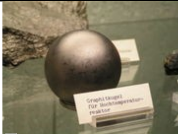
Graphitkugel für Hochtemperaturreaktor
